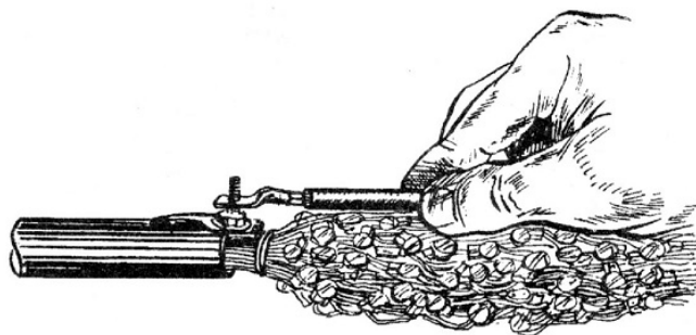
Рис. 10. Установка наконечника экранного провода на шпильку соединителя экрана.
