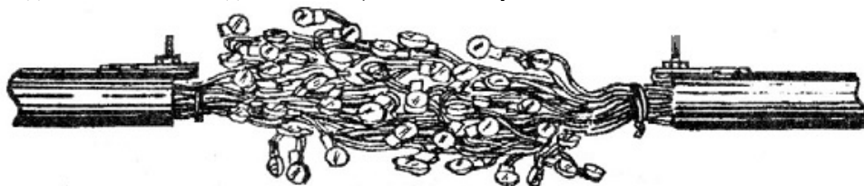
Рис. 10. Внешний вид сростка с установленными соединителями экрана. На обрезках оболочек установлены соединители экрана 4460-D.
