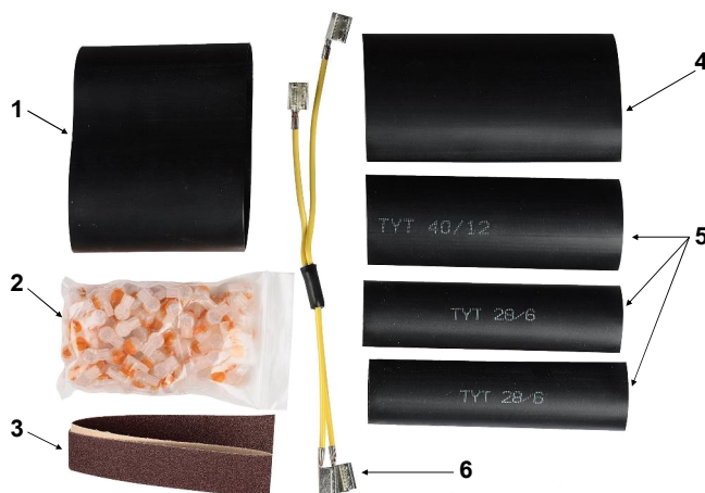
Рис. 4. Остальные детали комплекта «Муфта ЗМПП 1 для заполненных кабелей»: 1 – трубка ТУТ для стыка корпуса и оголовника; 2 – одножильные соединители для сращивания жил; 3 - шкурка шлифовальная; 4 - трубка ТУТ для ввода кабеля в конус корпуса; 5 – трубки ТУТ для ввода кабелей в патрубki оголовника; 6 - перемычка с 4-мя сжимаемыми соединителями экрана.
