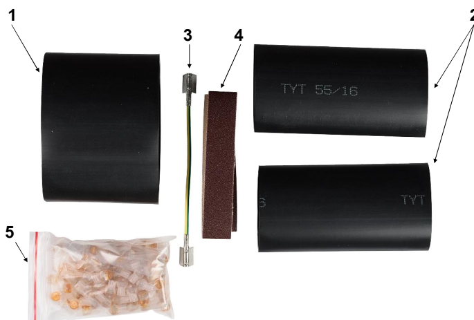
Рис. 2. Остальные детали комплекта «Муфта МПП 1 для заполненных кабелей»: 1 – трубка ТУТ для стыка полумуфт; 2 – трубки ТУТ для ввода кабелей в конусы; 3 – перемычка с двумя сжимаемыми соединителями экрана; 4 – шкурка шлифовальная; 5 – одножильные соединители для сращивания жил.
