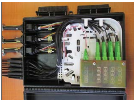
Рисунок А1 – Общий вид смонтированной муфты-креста с максимально возможным количеством введенных ОК
