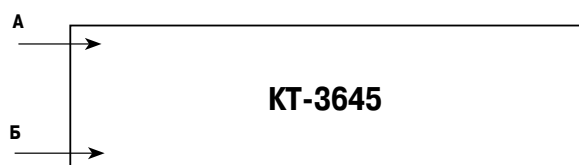
Схема "а": прямой односторонний ввод
