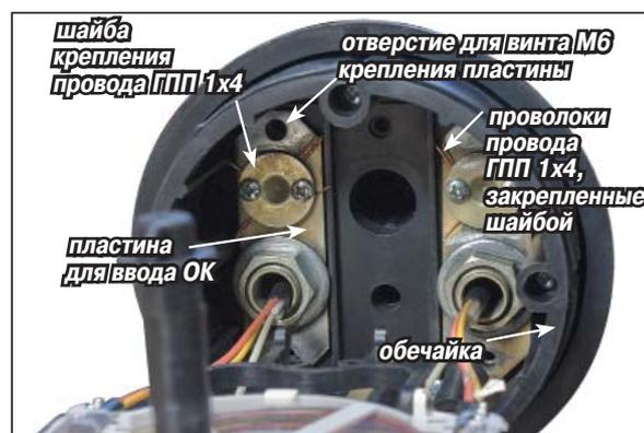
20 Закрепить ЦСЭ обоих ОК в узлах крепления ЦСЭ на обратной стороне кассеты для ОК (между скобой и пластиной) с помощью гаек, пользуясь торцовым ключом S=10 мм.
