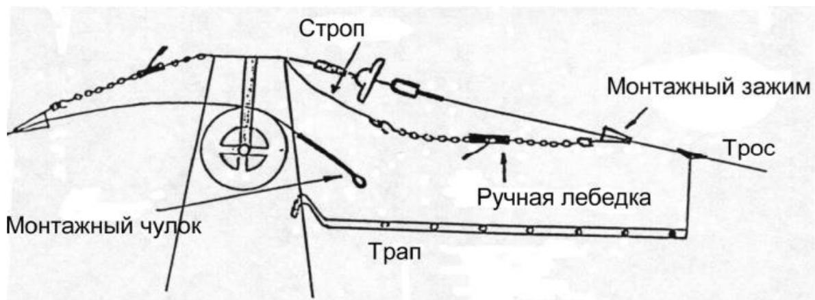
Рис. 7 Схема соединения грозозащитных тросов на анкерной опоре
