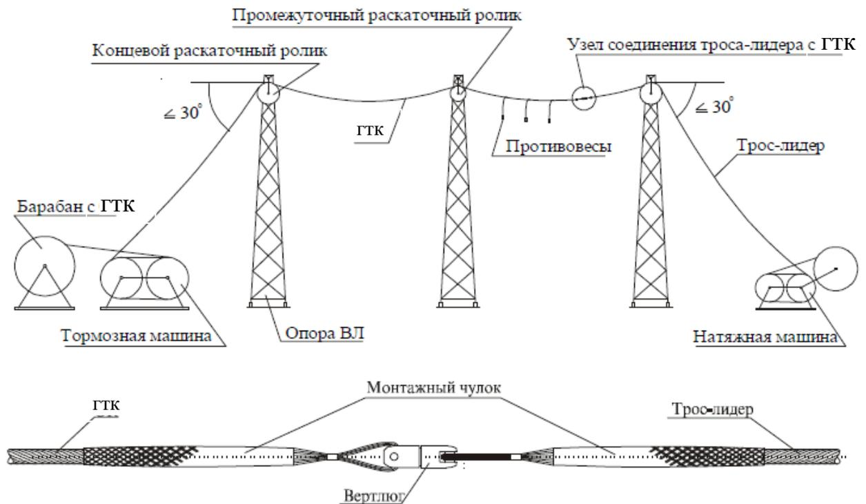
Рис. 10 Схема раскатки ГТК
