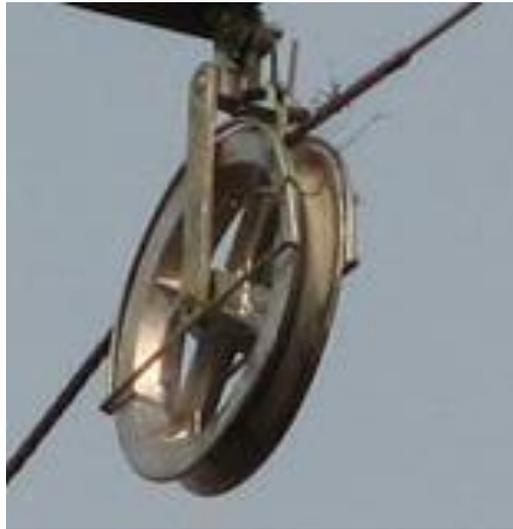
Рис. 3 Монтажный ролик
