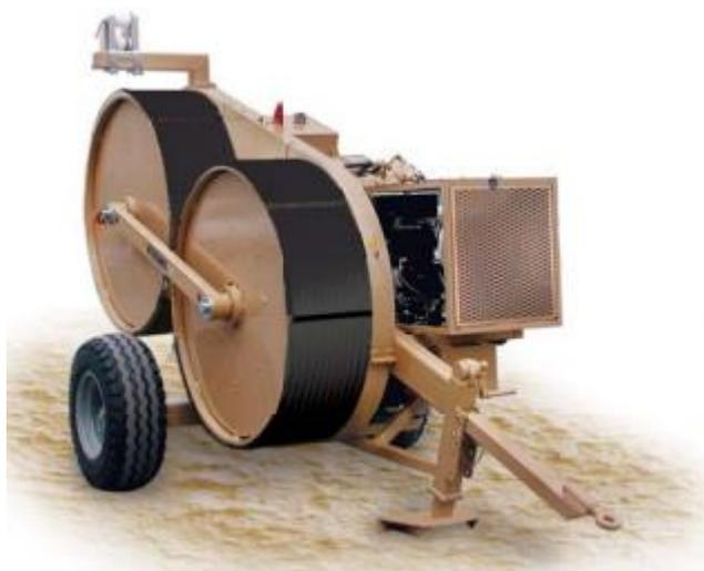
Рис. 9. Тормозная машина
