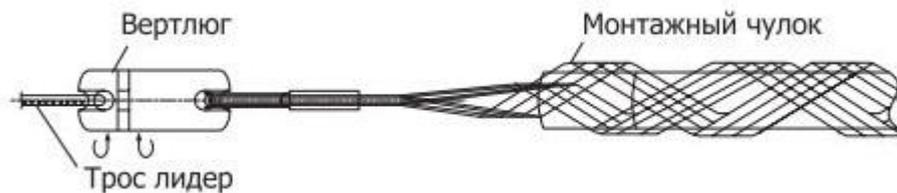
Рис.6 Схема установки монтажного чулка
