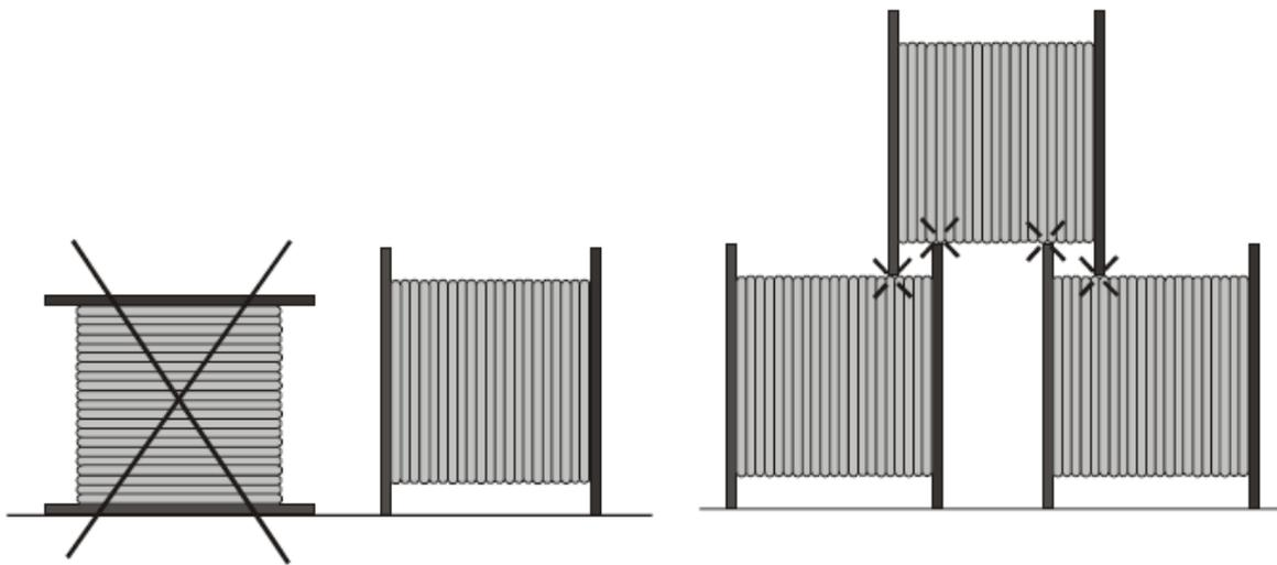
Рис. 1 Требования при транспортировке и хранении барабанов
