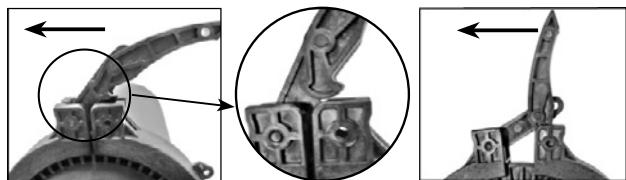
2. Подключить к алюмополиэтиленовой оболочке зажим зубчатый провода электрического соединения (перемычки) длиной 150 мм:
