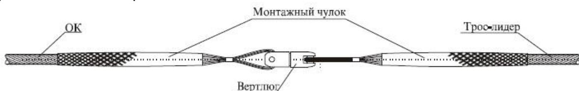
Рис. 2 Схема установки компенсатора кручения (вертлюга)
