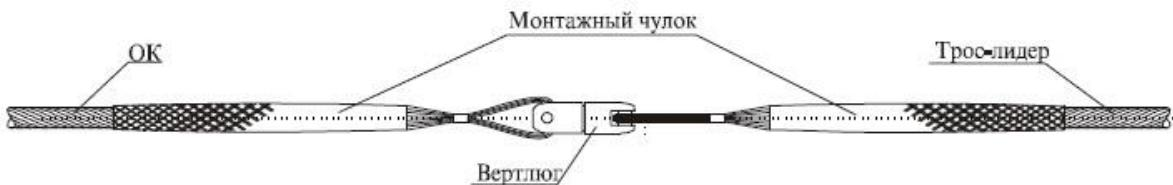
Рис. 2 Схема установки компенсатора кручения (вертлюга)
