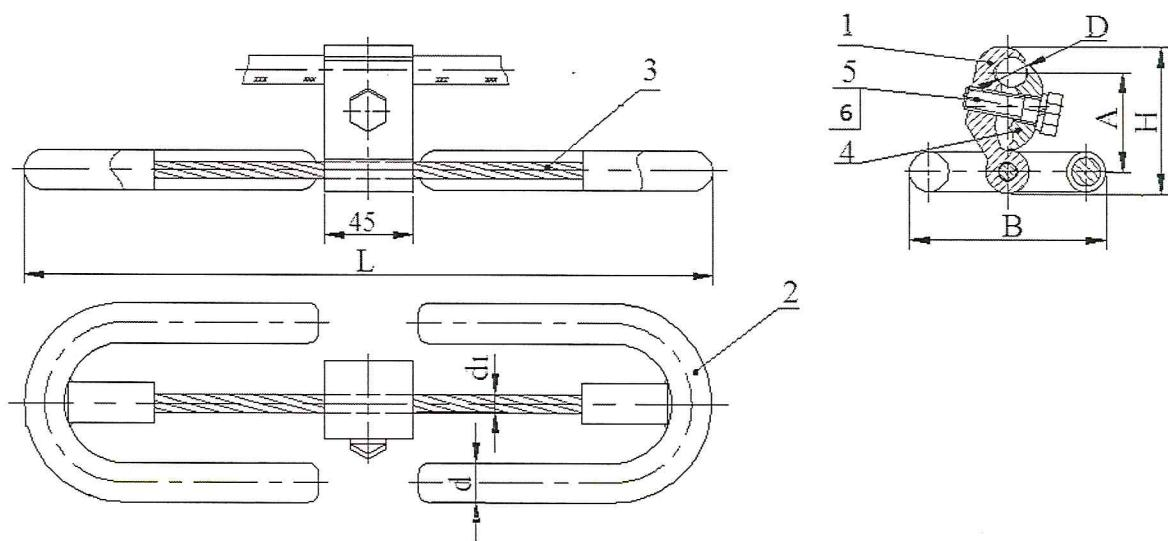
1- Корпус, 2- Груз, 3- Упругий элемент, 4-Плашка, 5- Болт, 6- Шайба
